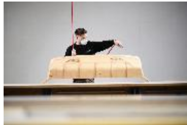
Holzleichtbau- Komponente der Weitzer Woodsolutions. Hier am Bild: Heck-Stoßstange für einen Porsche 914 electric
